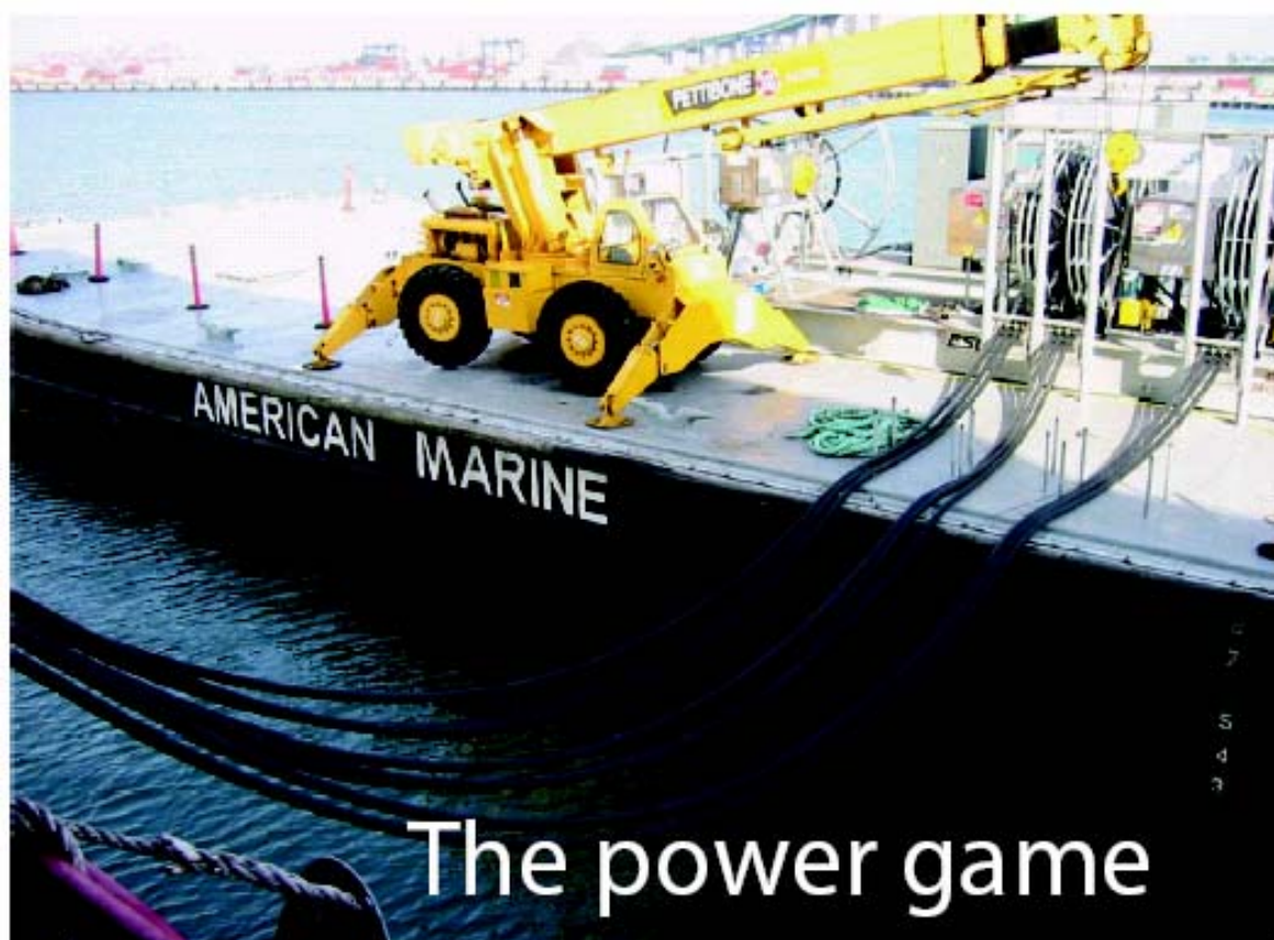
(写真)ロサンゼルス港では岸側から船舶への供給電源としてバージが選ばれた。
